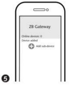
Нажмите "+" (Добавить дополнительное устройство), чтобы выбрать подходящий шлюз продукта и следуйте инструкциям на экране для сопряжения.
